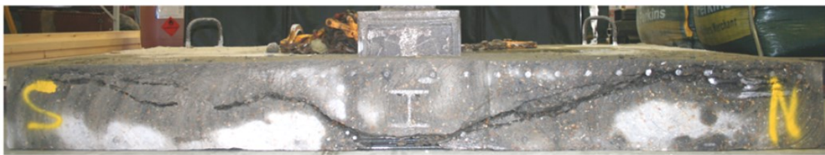
Рис. 18. Разрушение экспериментальной модели. Опыт без пластины и без поперечной арматуры (HS13-00) [9]
