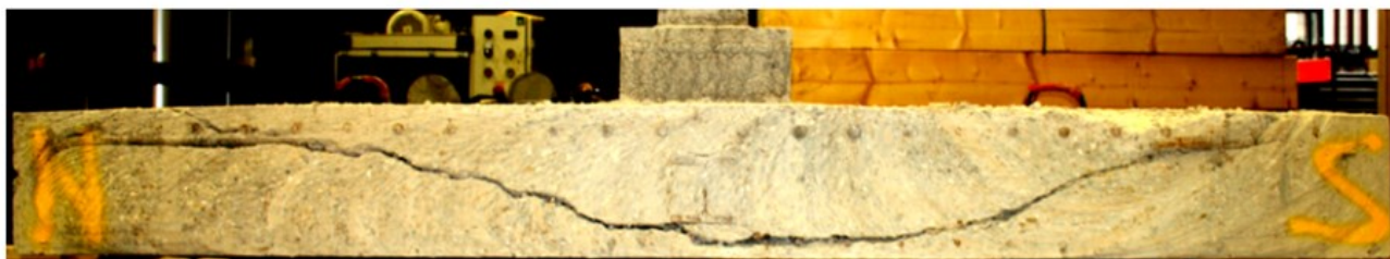
Рис. 6. Разрушение экспериментальной модели. Опыт с пластиной без поперечной арматуры (HS13-C0) [9]
